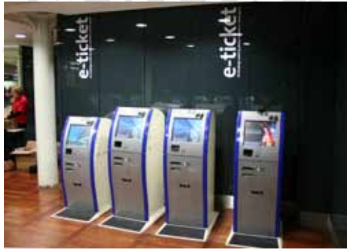
شكل رقم ٢٤: مثال آخر على مماكنات صرف التذاكر ومماكنات البيع التي توجد على ارتفاعات مختلفة. لاحظ أن نضد صرف التذاكر الأكثر انخفاضاً يتوافر معه حيز جانبي وحيز اقتراب من جهة الأمام كافيان. يوروستار.
